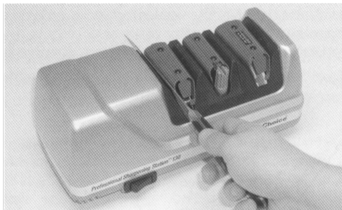
Kép 3 – 3. szakasz. A penge behelyezése a lejtő és a rugalmas rugó közötti lyukba
